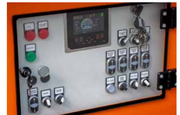
Funkcyjny pulpit sterowniczy pozwala monitorować i ustawiać parametry pracy przenośnika
