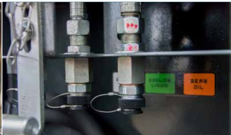
Centralny system wymiany płynów eksploatacyjnych wyprowadzony na zewnątrz maszyny po lewej i prawej stronie przerzucarki.
