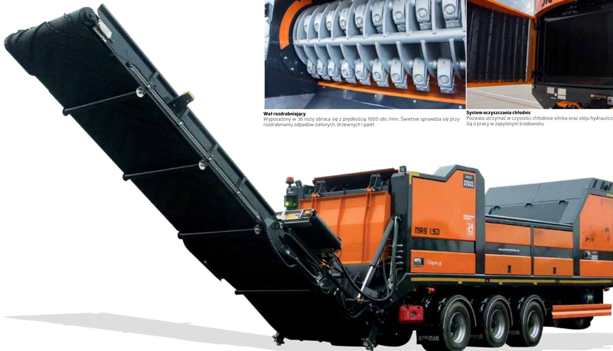
Sito Wielkość otrzymywanej frakcji jest regulowana poprzez wymienne sito umieszczone pod wałem rozdrabniającym. Innowacyjna technologia cięcia wodą pozwala zachować najistotniejsze właściwości materiału podczas obróbki.
