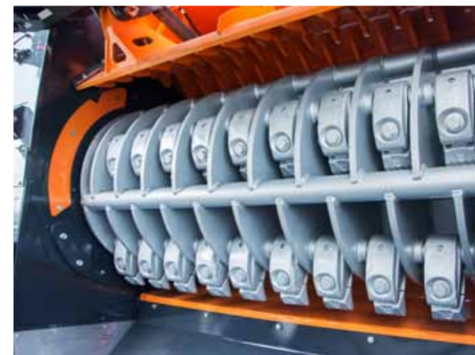
Wał rozdrabniający Wyposażony w 36 noży obraca się z prędkością 1000 obr./min. Świetnie sprawdza się przy rozdrabnianiu odpadów zielonych, drzewnych i palet
