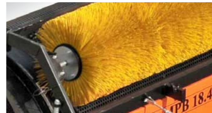
Szczotka czyszcząca bęben opuszczana i podnoszona hydraulicznie
