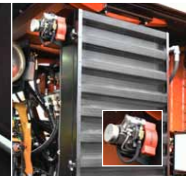
System Cleanfix automatycznie oczyszcza chłodnicę silnika oraz oleju hydraulicznego
