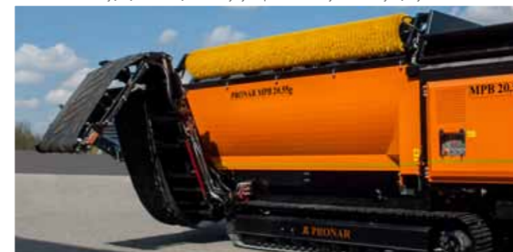
Przenośniki składają się na zewnątrz maszyny co pozwoliło uzyskać mniejszą wysokość
