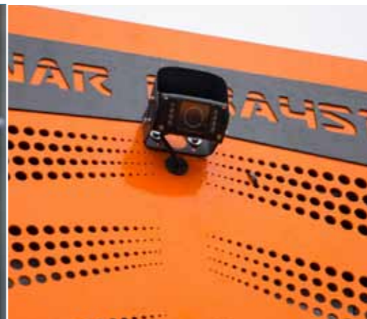
Kamera zapewnia widoczność z tyłu przerzucarki ułatwiając pracę i podnosząc poziom bezpieczeństwa
