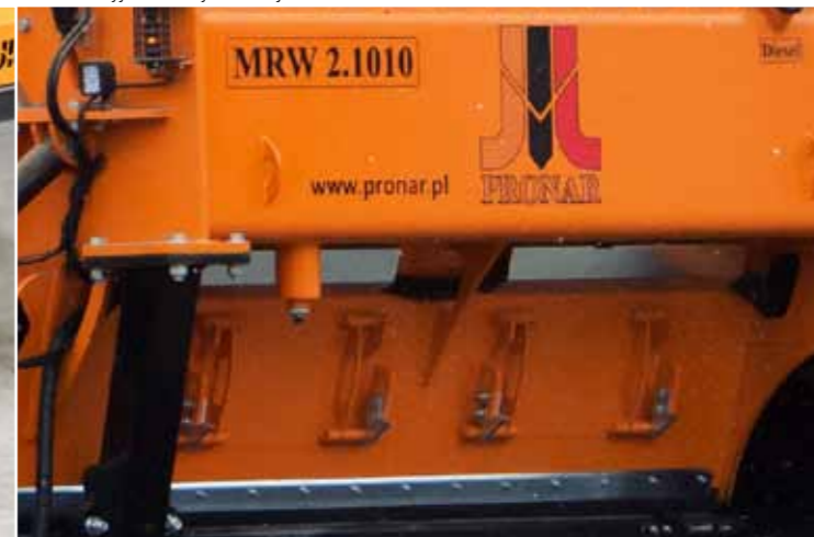
Okna rewizyjne komory roboczej
