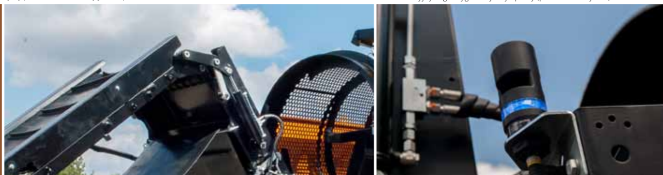
Tyłny przenośnik składany jest za pomocą dwóch siłowników
