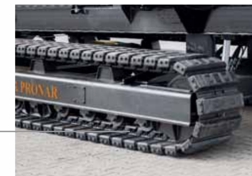
Układ hydraulicznego unoszenia ramy MPB 20.55gh pozwala wy poziomować maszynę do pracy na pochyłościach wzdłużnych i zwiększa prześwit ułatwiając pokonywanie nierównego terenu.
