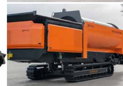
Układ hydraulicznego unoszenia ramy MPB 20.55gh pozwala wy poziomować maszynę do pracy na pochyłościach wzdłużnych i zwiększa prześwit ułatwiając pokonywanie nierównego terenu.
