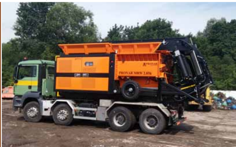
MRW 2.85h - transport na nośnikach z ramą hakowca
