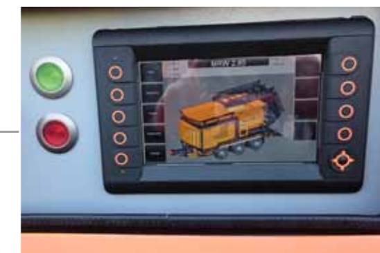
Dotykowy panel sterujący wszystkimi funkcjami maszyny
