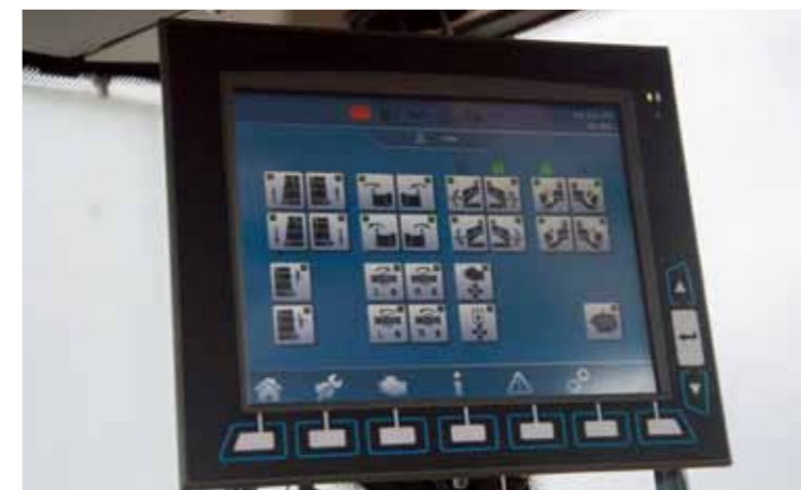
Zasilanie postojowe pozwala na obsługę przerzucarki bez uruchamiania silnika spalinowego w celu przeprowadzenia serwisowania i konserwacji.
