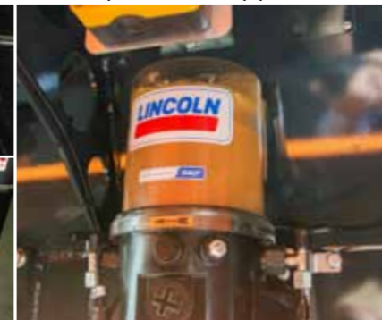
Pompa centralnego smarowania zapewnia dobrą kondycję smarną najważniejszych elementów maszyny
