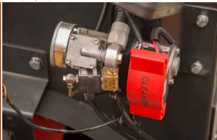
Przy pracy w trudnych warunkach i dużym zapyleniu, w trosce o niezawodność działania układu chłodzenia silnika i oleju hydraulicznego, chłodnice zostały wyposażone w system automatycznego oczyszczania (Cleanfix).
