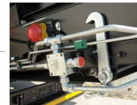
Regulacja prędkości przesuwu taśmy podajników – umożliwia dostosowanie prędkości do rodzaju przesiewanego materiału tak, aby maksymalnie wykorzystać oferowaną wydajność mobilnego przesiewacza bębnowego. Pozwala również na usypanie większej ilości materiału każdej z frakcji bez konieczności przemieszczania maszyny
