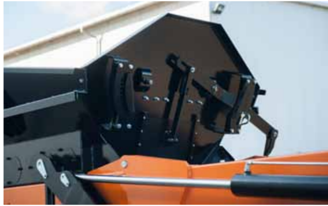
Zasuwa kosza zasypowego zabezpiecza przed zbyt szybkim wypływem materiału z kosza
