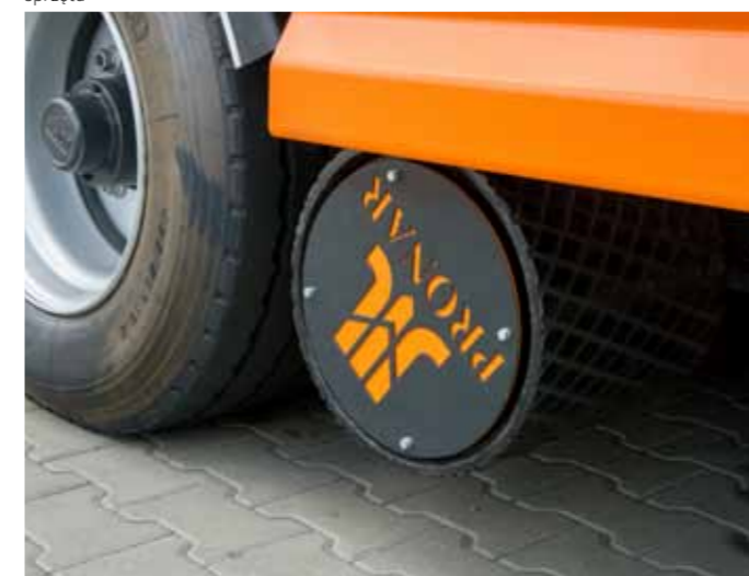
Self-crawler Maszyną można wykonać podstawowe manewry bez konieczności angażowania dodatkowego sprzętu
