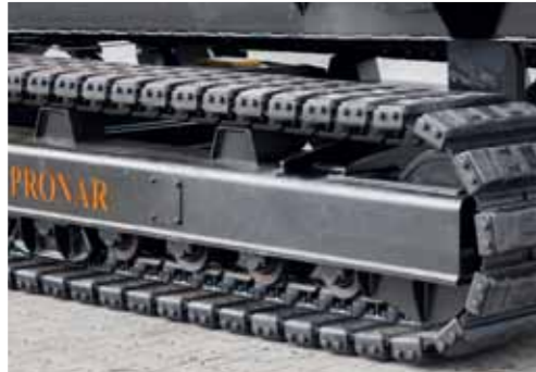
Gumowe nakładki na gąsienice chronią podłoże przed porysowaniem stalowymi klepkami.
