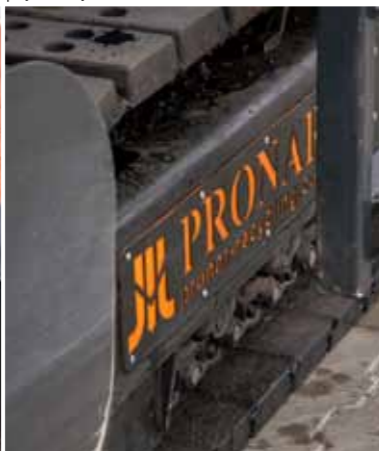
Napęd gąsienicowy pozwala na wygodne manewrowanie maszyną i poruszanie się z prędkością do 4km/h.
