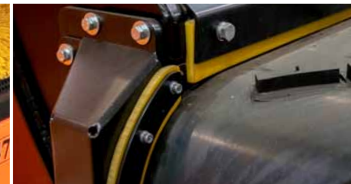
Uszczelnienia w koszu zasypowym chronią przed przedostawaniem się materiału wsadowego do wnętrza maszyny.
