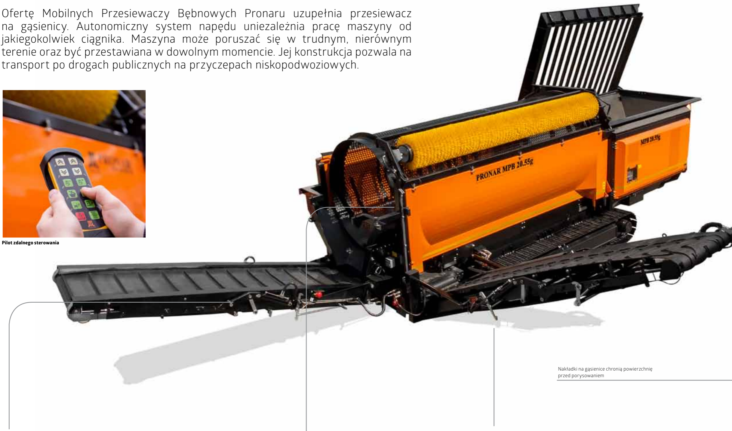
Tyłny przenośnik składany jest za pomocą dwóch siłowników
