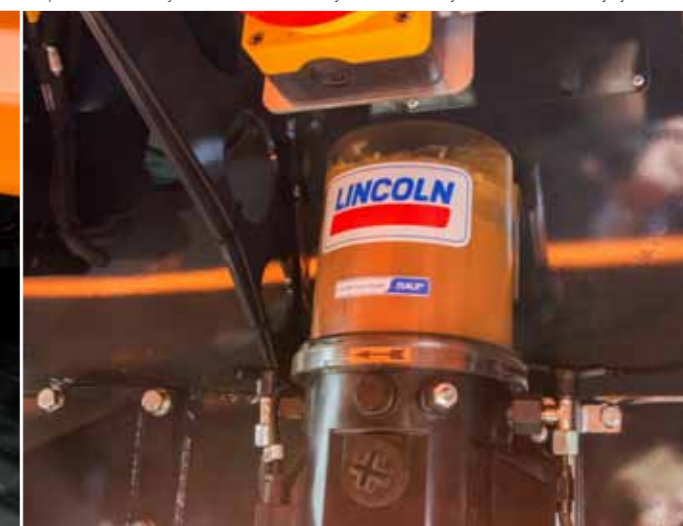
System centralnego smarowania Zapewnia automatyczne smarowanie wszystkich kluczowych elementów maszyny
