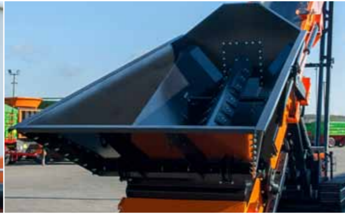
Belka z regulowanymi przepustnicami odciąża taśmę i eliminuje obciążenia dynamiczne podczas załadunku
