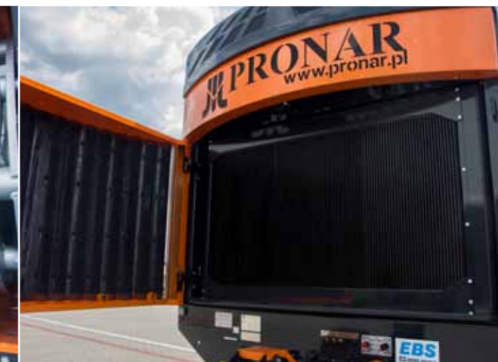
System oczyszczania chłodnic Pozwala utrzymać w czystości chłodnicę silnika oraz oleju hydraulicznego. Zaprojektowany z myślą o pracy w zapyłonym środowisku
