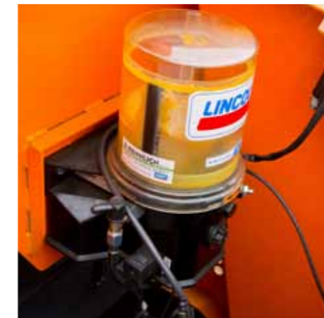
Układ centralnego smarowania poprawia komfort pracy i zapewnia ciągłość smarowania najważniejszych punktów maszyny wydłużając jej żywotność
