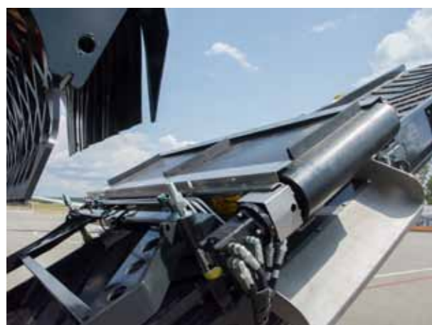
Separator magnetyczny Zastosowanie neodymowego magnesu zapewnia skuteczne oddzielenie z materiału elementów ferromagnetycznych
