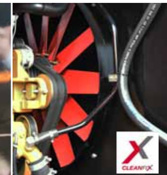
Pompa centralnego smarowania zapewnia dobrą kondycję smarną najważniejszych elementów maszyny
