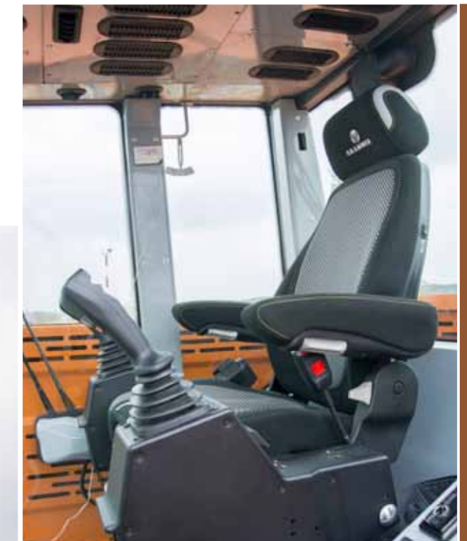
W trosce o komfort operatora w kabinie został zamontowany fotel na zawieszaniu pneumatycznym z automatycznym pozycjonowaniem, regulacją wagi, tłumieniem drgań.
