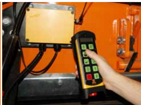
Pilot zdalnego sterowania pozwala operatorowi na regulację parametrów pracy maszyny bez wysiadania z kabiny ładowarki
