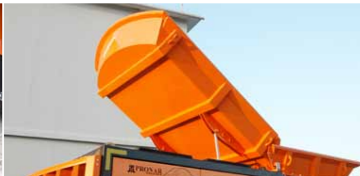
Hydraulicznie unoszona rynna zsykowa ułatwia wprowadzanie nadgabarytowych materiałów do komory roboczej
